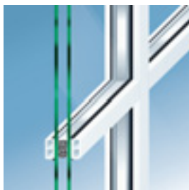
Die Gliederung der Fensterflächen mit Sprossen: Für Altbau oder Landhaus-Stil eines der wichtigsten und schönsten Gestaltungselemente.
