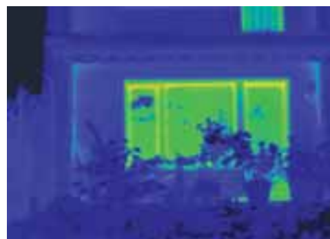
Nach dem sorgfältigen Einbau neuer Corona CT 70-Fenster beweist die Thermografie den hohen energetischen Nutzen der Investition. Der ursprüngliche Energieverlust wird nahezu vollständig vermieden.
